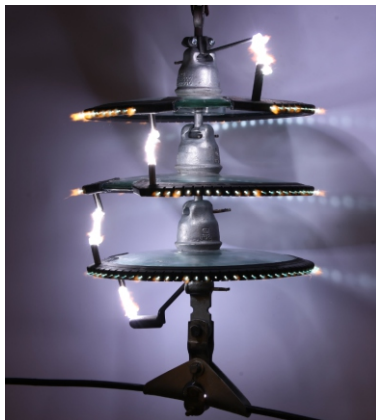
Рисунок 7 - Фотография срабатывания ГИРМК
